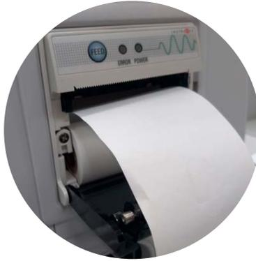
3 - Coloque a nova bobina. O rolo de papel deve estar posicionado conforme figura acima.
